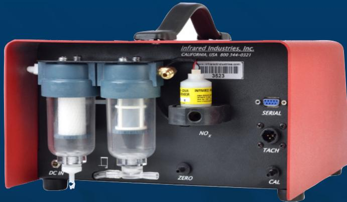
El analizador de gas FGA4500 cuenta con un sistema de filtración doble que le permite filtrar desechos ligeros y pesados así como bloquear el paso de agua, de esta manera la unidad puede trabajar correctamente incluso en condiciones extremas.
